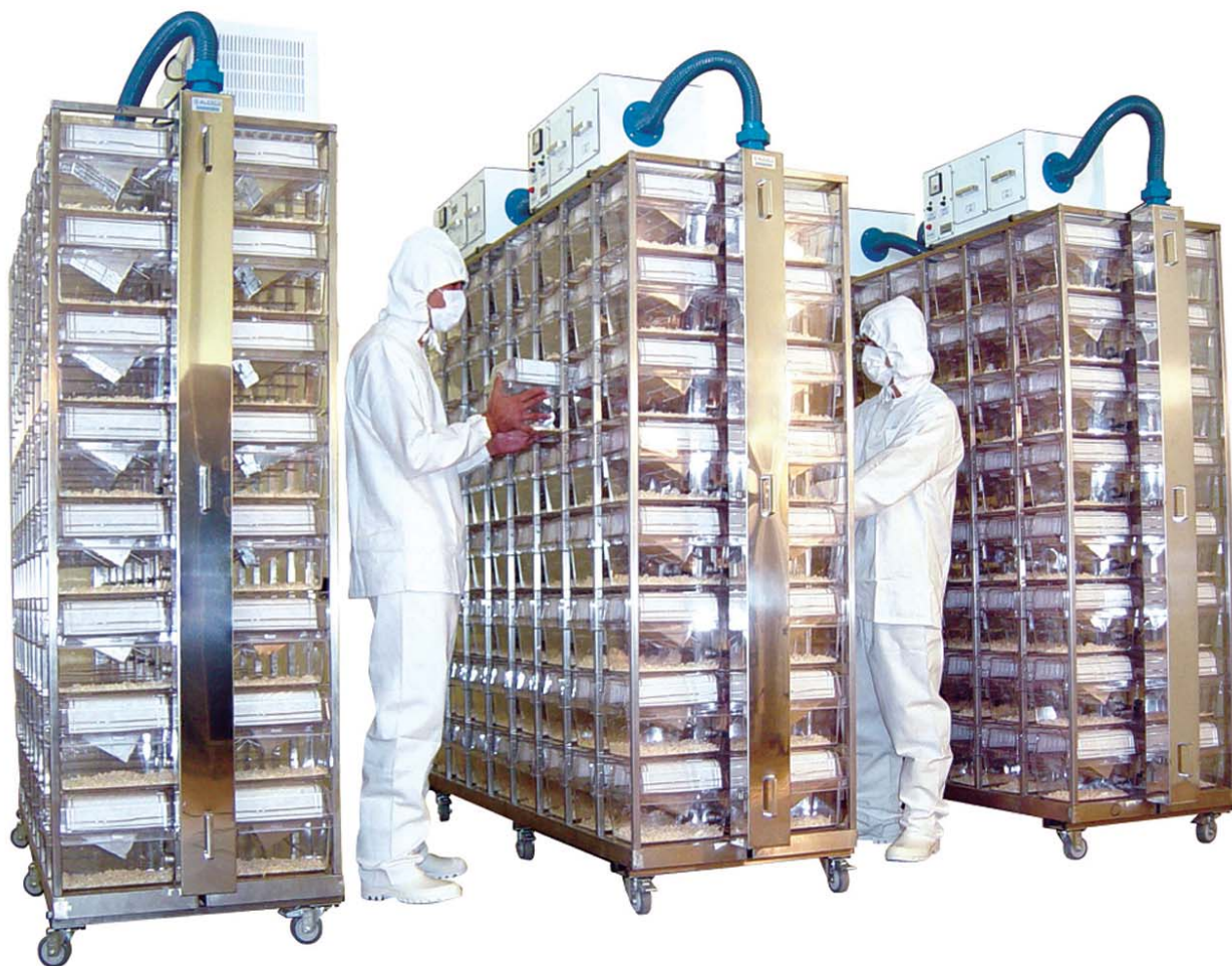
Sistema de microisoladores ( Racks ventilados ) IPEN/CNEN/SP
