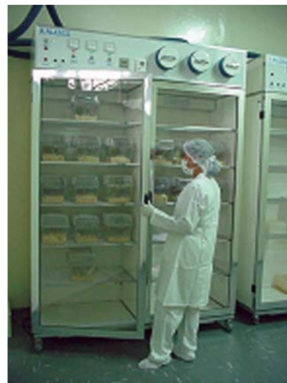
Microisoladores dentro de Estantes Ventiladas - IPEN/CNEN/SP
