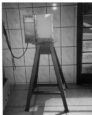
Figura 4.2 Moagem do Malte de Cevada (EEL USP, 2010)
